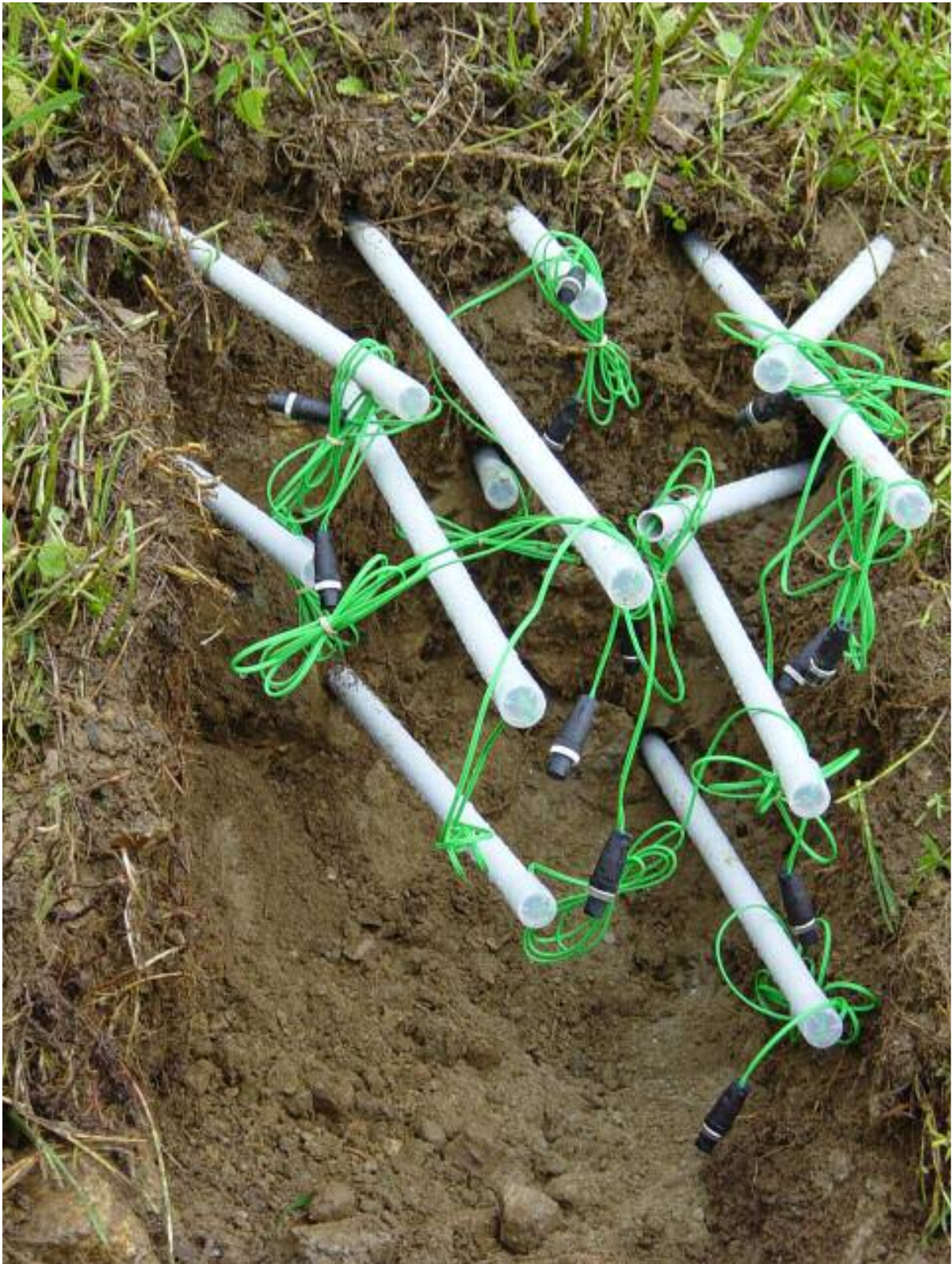
Abbildung 8: Einbau der Gipsblockensoren im Wurzelbereich des Weinstocks über Profil 1
