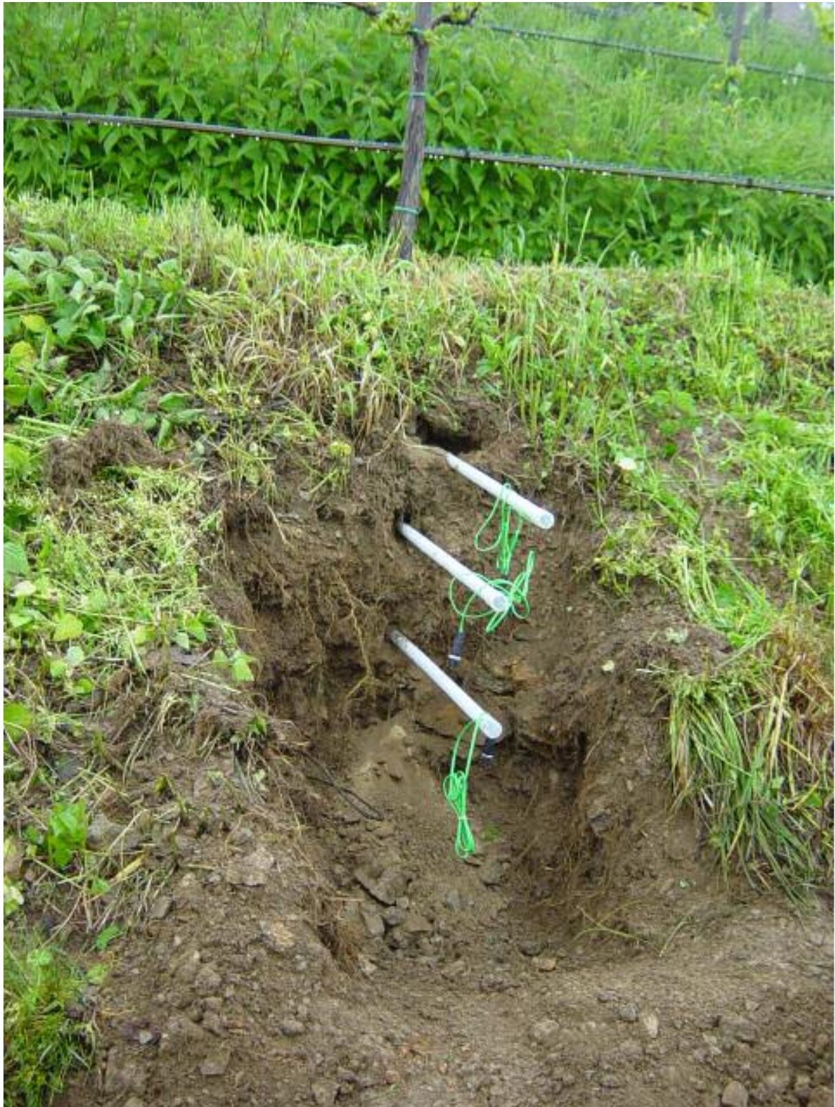
Abbildung 9: Einbau der Gipsblocksensoren im Wurzelbereich des Weinstocks über Profil 2
